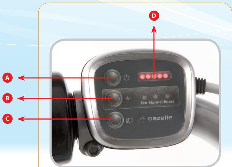
**Das Display befindet sich an der linken Seite des Lenkers und ist nicht abnehmbar. Nachstehend folgt eine Übersicht über die verschiedenen Angaben auf dem Display.**
