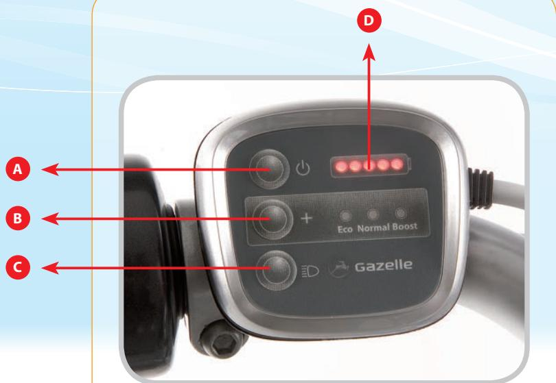
De display bevindt zich links op uw stuur en is niet afneembaar. Hierbij vindt u een overzicht van de verschillende aanduidingen op uw display.
